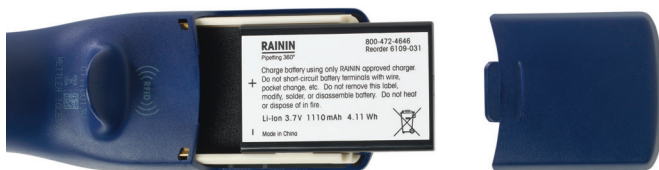
Figure 5 : Installation de la batterie principale
